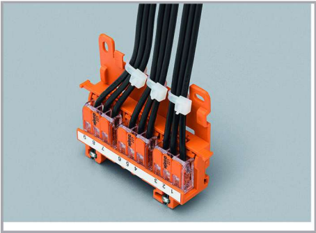
Verticale schroefmontage met trekontlastingsplaat op een glad oppervlak
