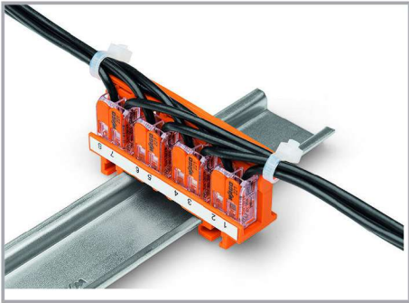
Trekontlasting door kabelbinder aan de adapter, dwars ten opzichte van de aansluitrichting van de klemmen; markering van de klemposities met markeringsstrook (210-334)
